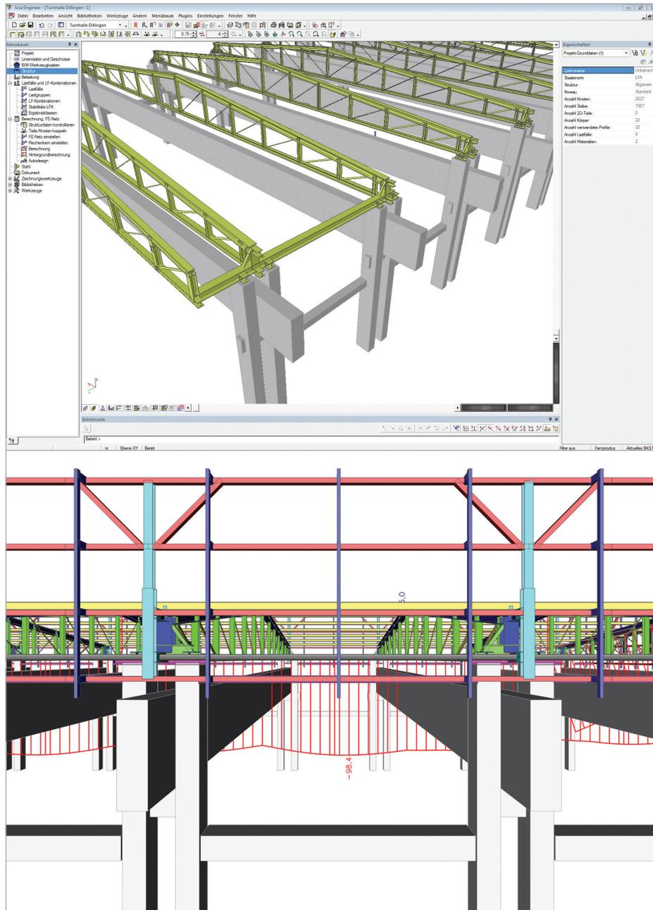
Aufgrund einer nicht ausreichend tragfähigen Trapezblechdachendeckung wurde eine umfangreiche Sanierung einer Dreifachturnhalle (Baujahr 1974) notwendig, wobei zusätzlich eine Verbesserung der energetischen Hülle sowie der Architektur durchgeführt werden sollte.
