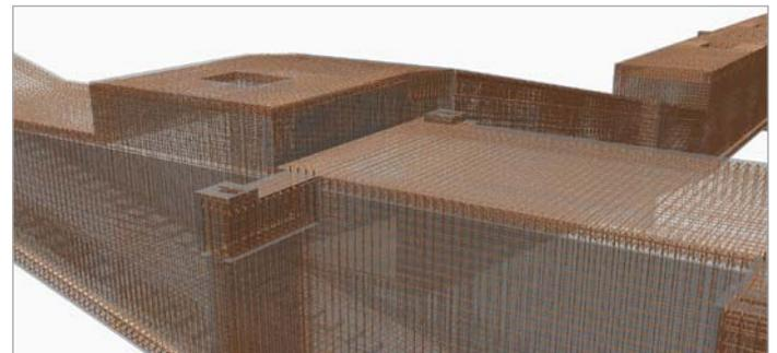
Situé dans la carrière de Gaurain-Ramecroix, le projet concerne l'installation d'un nouveau stock pile couvert d'une longueur de 140 m pour une portée libre de 48 m et une hauteur de tas exploitable de 23 m, ainsi que les ouvrages nécessaires à son exploitation : galeries de reprises, transporteurs de remontée vers l'usine, tours d'angle, tours de concassage secondaires, massifs de support des nouveaux concasseurs, installation de filtres...
